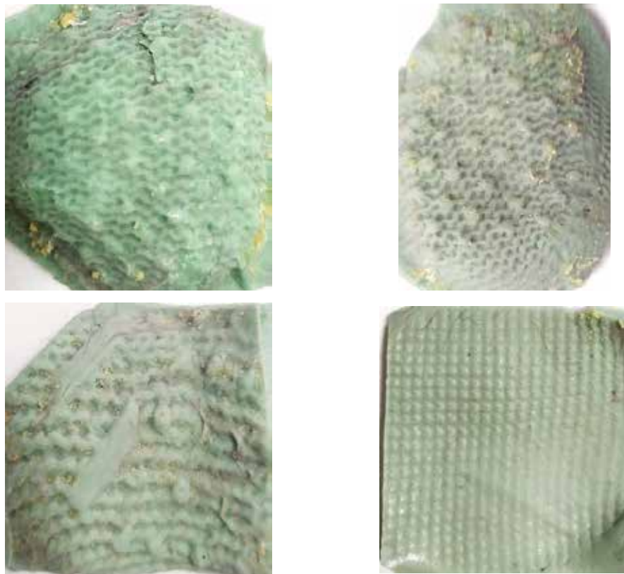
Рис. 3. Загальний вигляд об'ємних слідів тканини, що перекопійовані шляхом виготовлення полімерних зліпків
